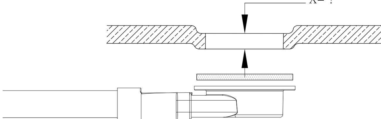
Pour assurer une compatibilité parfaite avec les cabine Horizon Hammam, Eden, ou Kineform, utiliser la bonde livrée avec la cabine.
