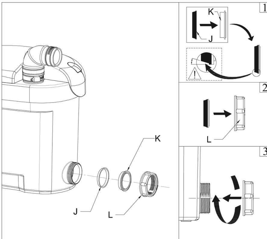
1. Insérez le joint conique (J) sur le bouchon (K) en respectant le sens indiqué (la partie la plus épaisse du joint doit être en contact avec la portée du bouchon)
